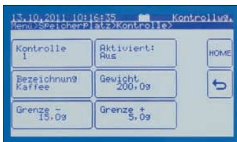
40 emplacements de mémoire par mode de fonctionnement par exemple pour le Checkweighing, la prêtare, le poids de référence, la valeur visée pour le dosage, etc.
