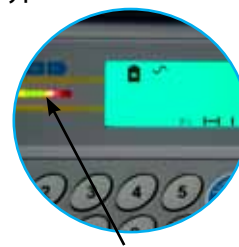
LED des limites pour le contrôle de pesée
