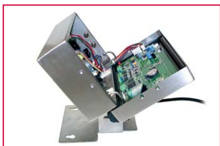
Charnière de maintien pour faciliter le service
